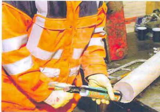
Bild 6: Setzen einer Silikonplombe unmittelbar nach Probenauswahl bei einem veränderlich festen Mergelstein, der mittels Mehrfachkernrohr und Kunststoff-Inliner gewonnen wurde.
