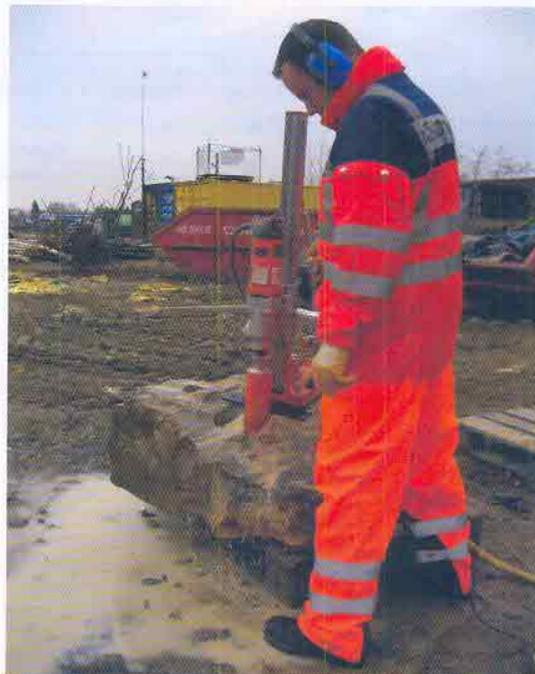
Bild 11. Entnahme von Kalkstein-Bohrproben mit Betonkernbohrgerät aus Kluttkörpern, die mittels Bagger aus dem Anstehenden gewonnen wurden.
